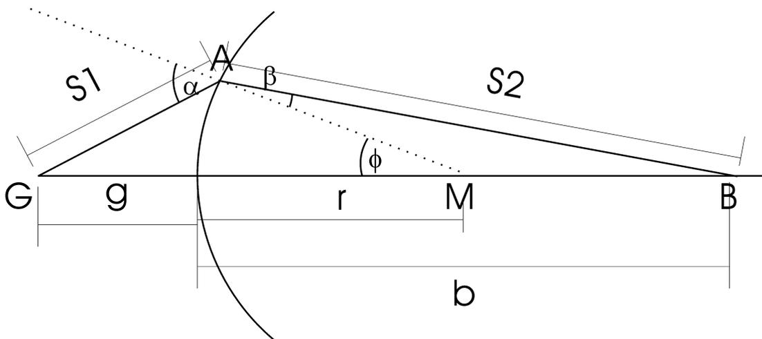
ein Lichtstrahl ausgeht, der auf das brechende Material trifft. Die Brechzahlen der beiden Medien sind  $n_1$  und  $n_2$ . Am Punkt  $A$  können wir das Brechungsgesetz anwenden
