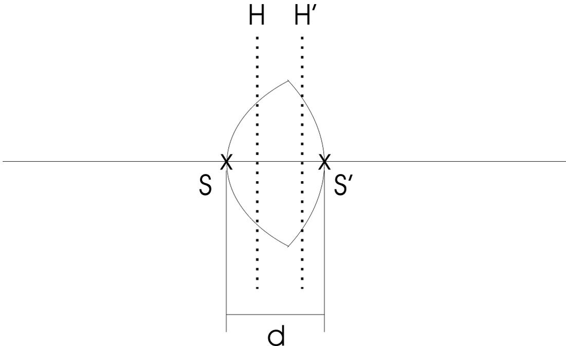
Beim Zusammensetzen von Linsen aus einzelnen gekrümmten Flächen erfolgt die Konstruktion durch Verfolgen des Strahlengangs. Wir werden dies nicht im einzelnen durchführen, sondern direkt das Konzept der Hauptebenen einführen. In der obigen Zeichnung sind die gegenstands- ( $H$ ) und bildseitige ( $H'$ ) Hauptebene eingezeichnet.
