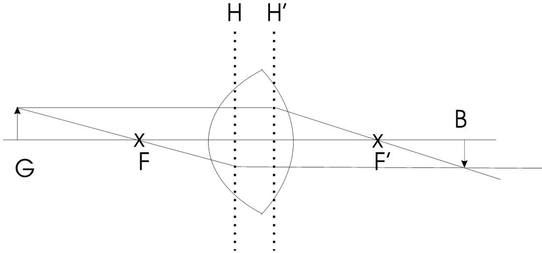
Wie man leicht in der Skizze erkennt zeichnet man vom Gegenstand aus einen achsparallelen Strahl bis zur Hauptebene  $H'$  (Bildseite) der zum Brennpunkt  $F'$  gebrochen wird. Der zweite Strahl geht vom Gegenstand durch den Brennpunkt  $F$  (Gegenstandsseite) bis zur Hauptebene  $H$  wo er achsparallel weiterläuft. Der Schnittpunkt der beiden Strahlen ergibt das Bild
